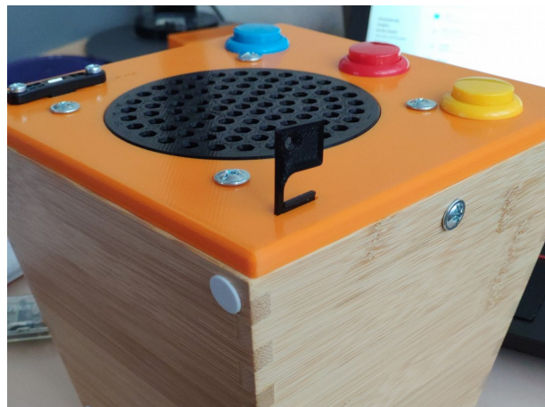
Abbildung 2: Mit Haken SD-Karte herausziehen
