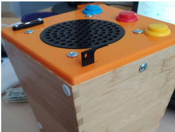
Abbildung 1: Mit breiter Seite des Werkzeugs SD-Karte entriegeln
