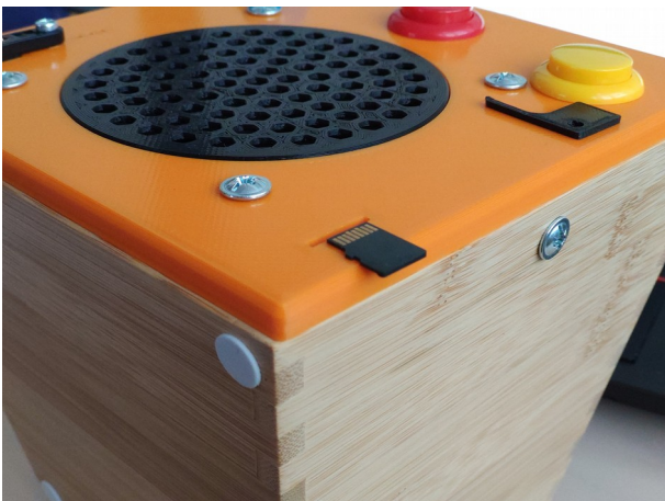
Abbildung 3: Orientierung der SD-Karte im Slot
